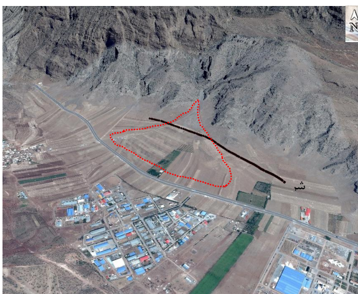
شکل ۱۵: موقعیت مخروطافکنه دامنه کوه یافته و نیمرخ برداشت شده با استفاده از GPS با جهت شرق به غرب در جهت بررسی تغییرات ارتفاعی مخروطافکنه نسبت به محیط دشت (دید به سمت شمال غرب) تهیه و ترسیم: نگارندگان، ۱۳۹۶
