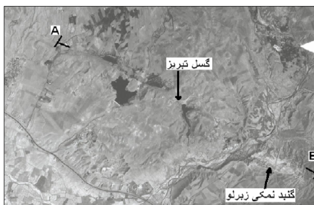
شکل ۳: عکس هوایی گسل تبریز و گنبد نمکی روی آن در جنوب روستای امند (جنوب شرقی مورو) A-B مسیر گسل تبریز را نشان می‌دهد.
