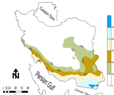
نقشه ۵: میانگین مجموع درجه ساعت نیاز سرمایه‌ش ماه اگوست ۰۹ دوره ۲۰۲۵-۲۰۶۰ (تهیه و ترسیم: نگارندگان، ۱۳۹۵)
